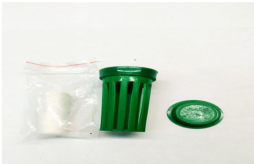
Рисунок 3 – Диспенсер – ватный тампон, обработанный смесью 4-метоксифенилового спирта и фенилацетальдегида и контейнер для его установки в ловушку «Бета» (фото авторов)
